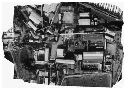
M350 RTK唐安煤矿工业场地全图幅免像控航测图
