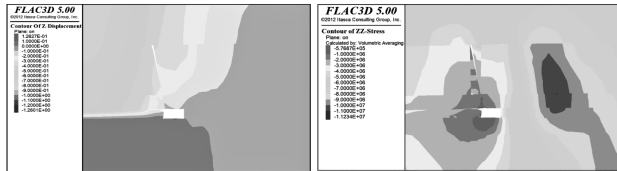
图3 支护补强后留巷围岩位移及应力云图
