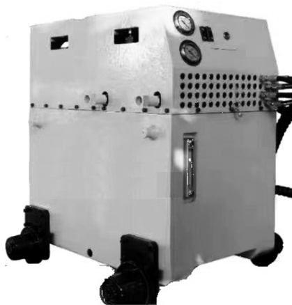
图5 机械造穴专用泵站
